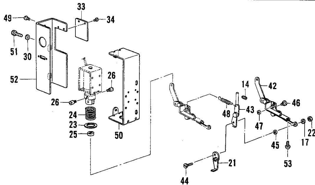
K. 糸扱い関係 / Thread wiper mechanism / Fadenwischvorrichtung / Mécanisme de tire-fil / Mecanismo del limpiador de hilo
