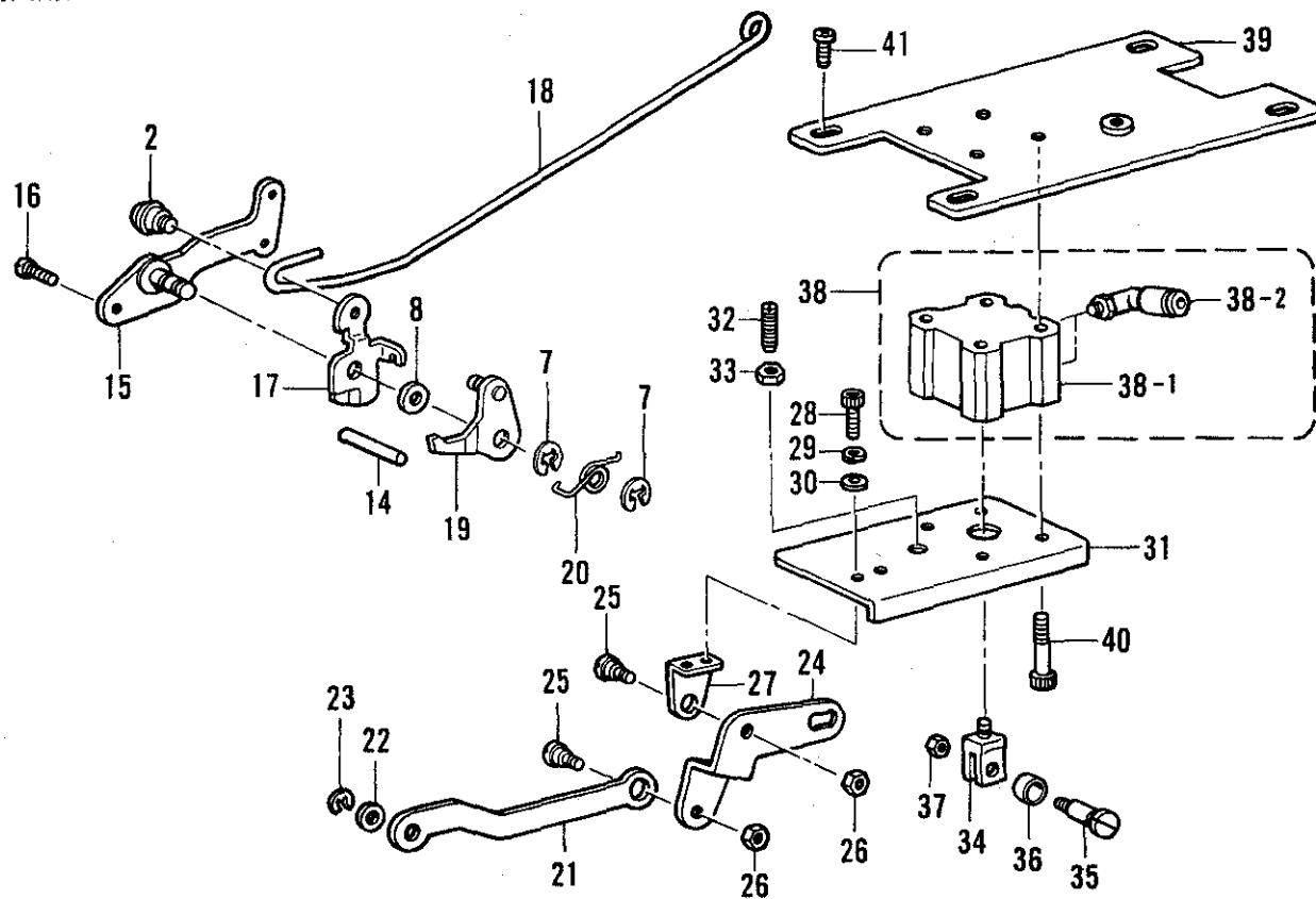
L. 糸締メ関係 / Thread nipper mechanism / Fadenspannvorrichtung / Mécanisme de pince-fil / Mecanismo de la mordaza para hilo
