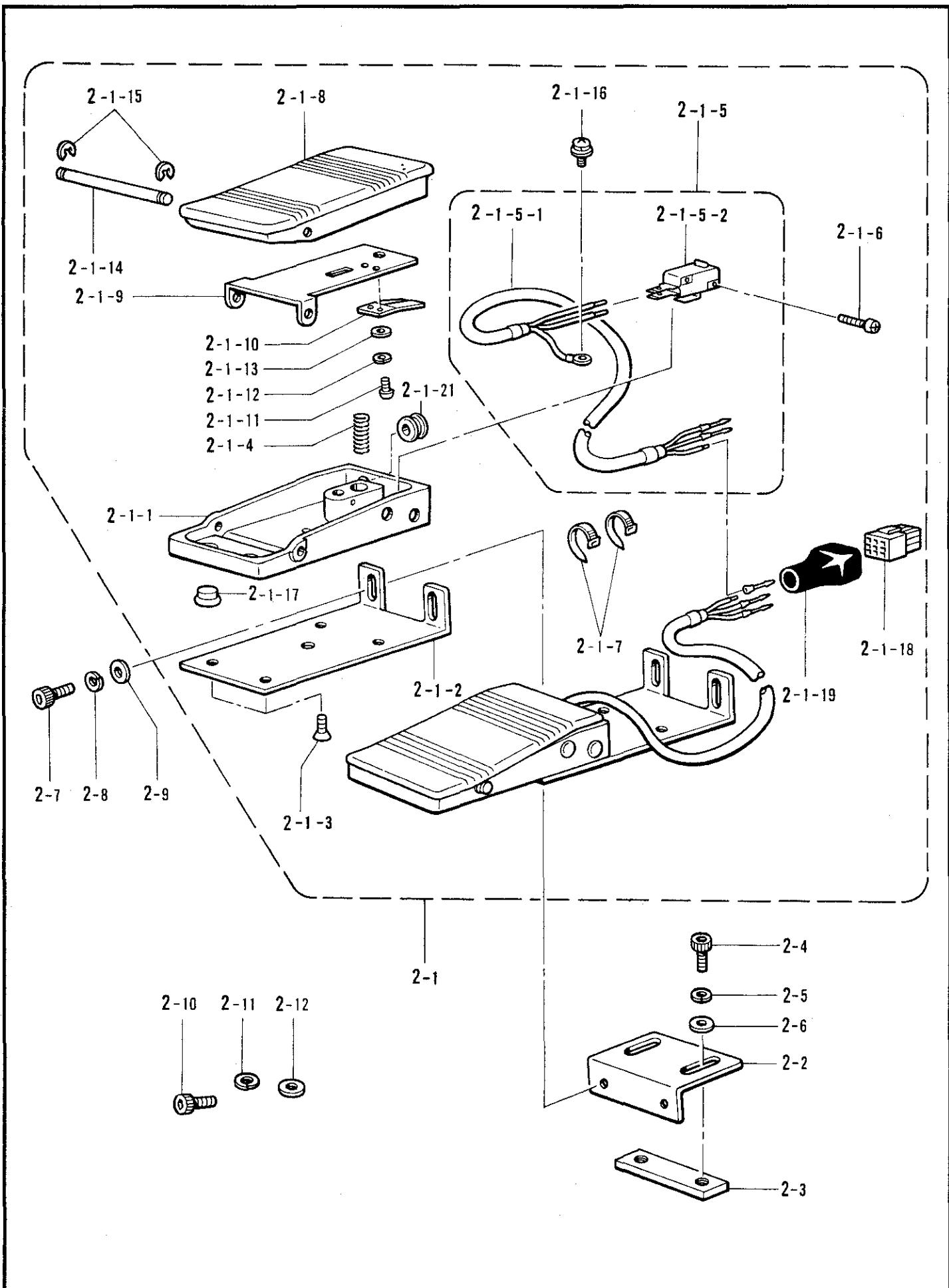
T2 . 踏板関係 / Foot switch pedal mechanism / Fußbetätigung / Mécanisme de la pédale / Mecanismo del pedal
