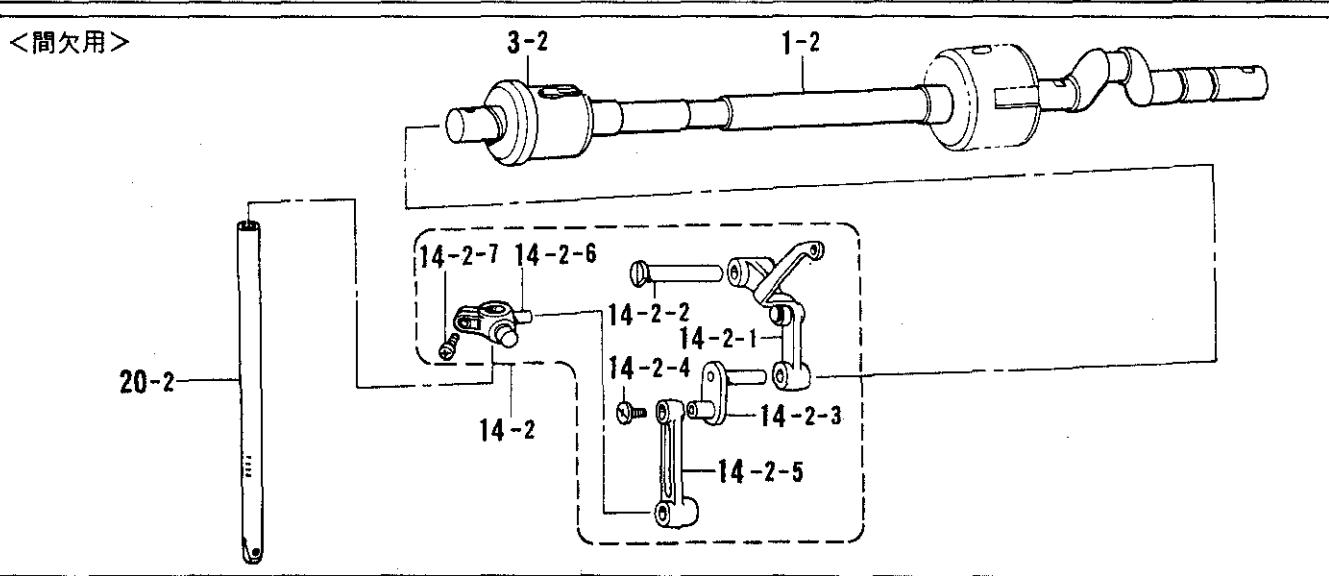
B. 上軸・針棒関係 / Upper shaft and needle bar mechanism / Obere Welle und Nadelstangenvorrichtung / Mécanisme de arbre supérieur et barra à aiguille / Mecanismo del eje superior y la barra de aguja
