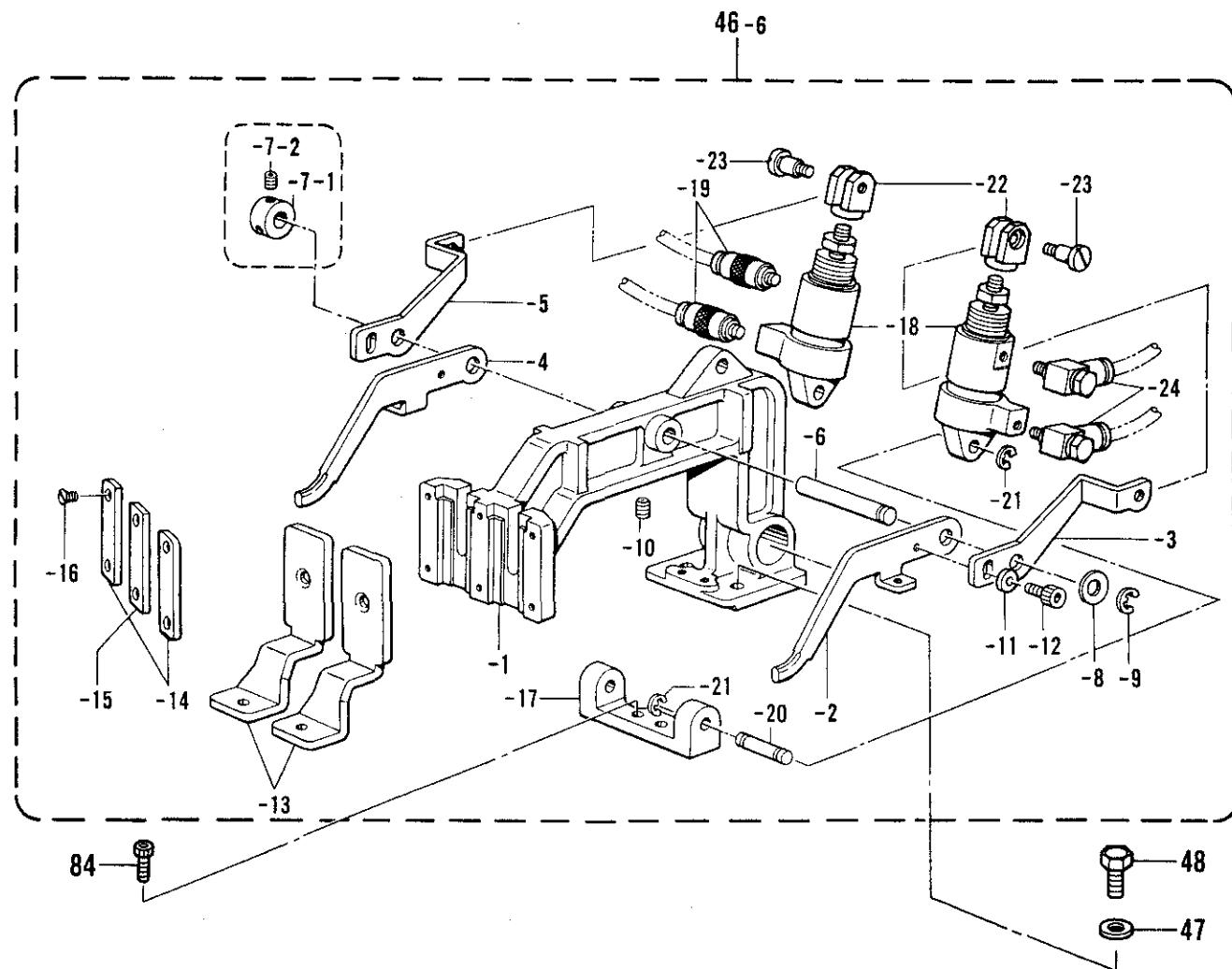
C3. 送り関係 / Feed mechanism / Transportvorrichtung / Mécanisme de l'entraînement /
