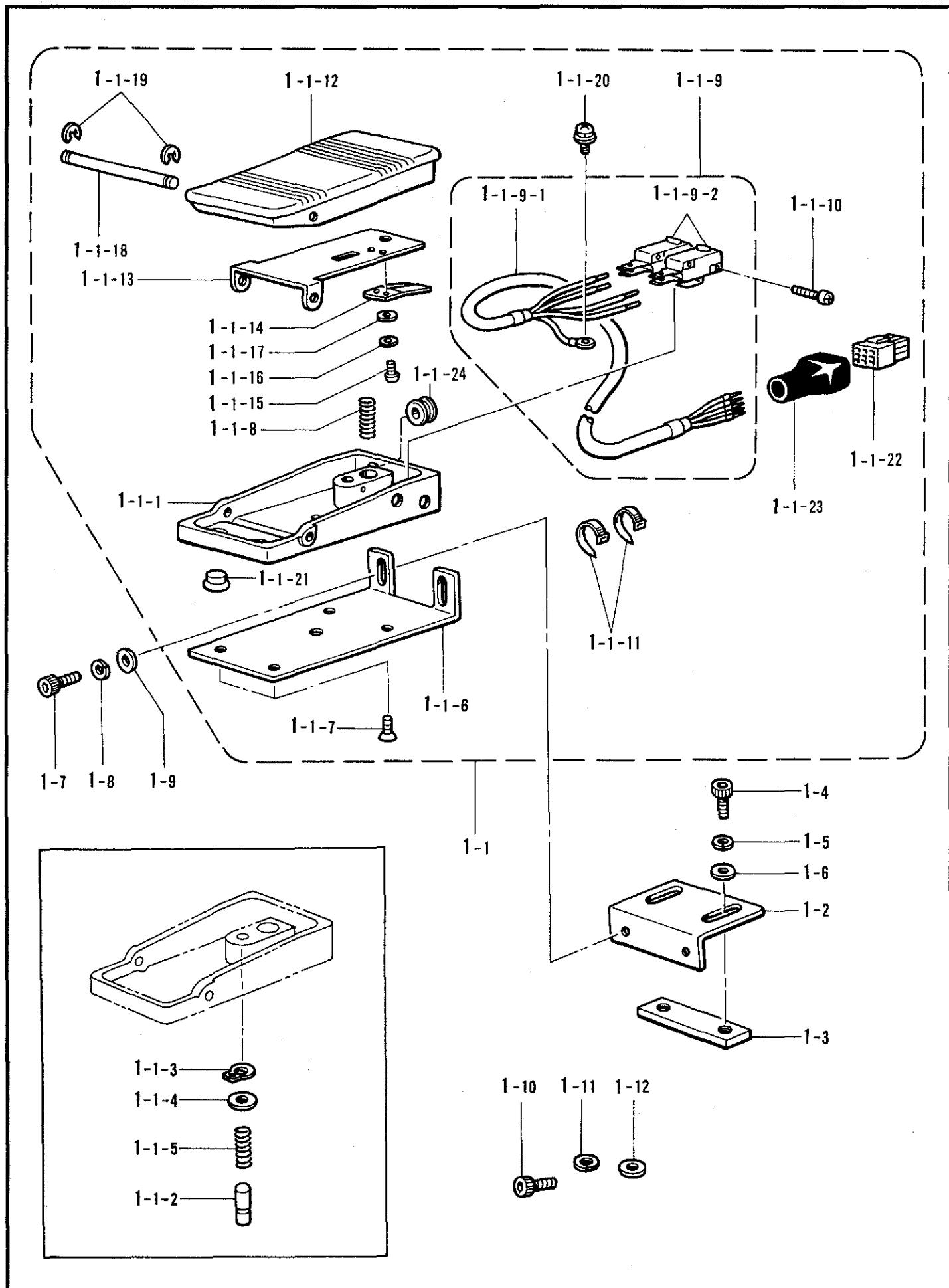
T1. 踏板関係 / Foot switch pedal mechanism / Fußbetätigung / Mécanisme de la pédale / Mecanismo del pedal
