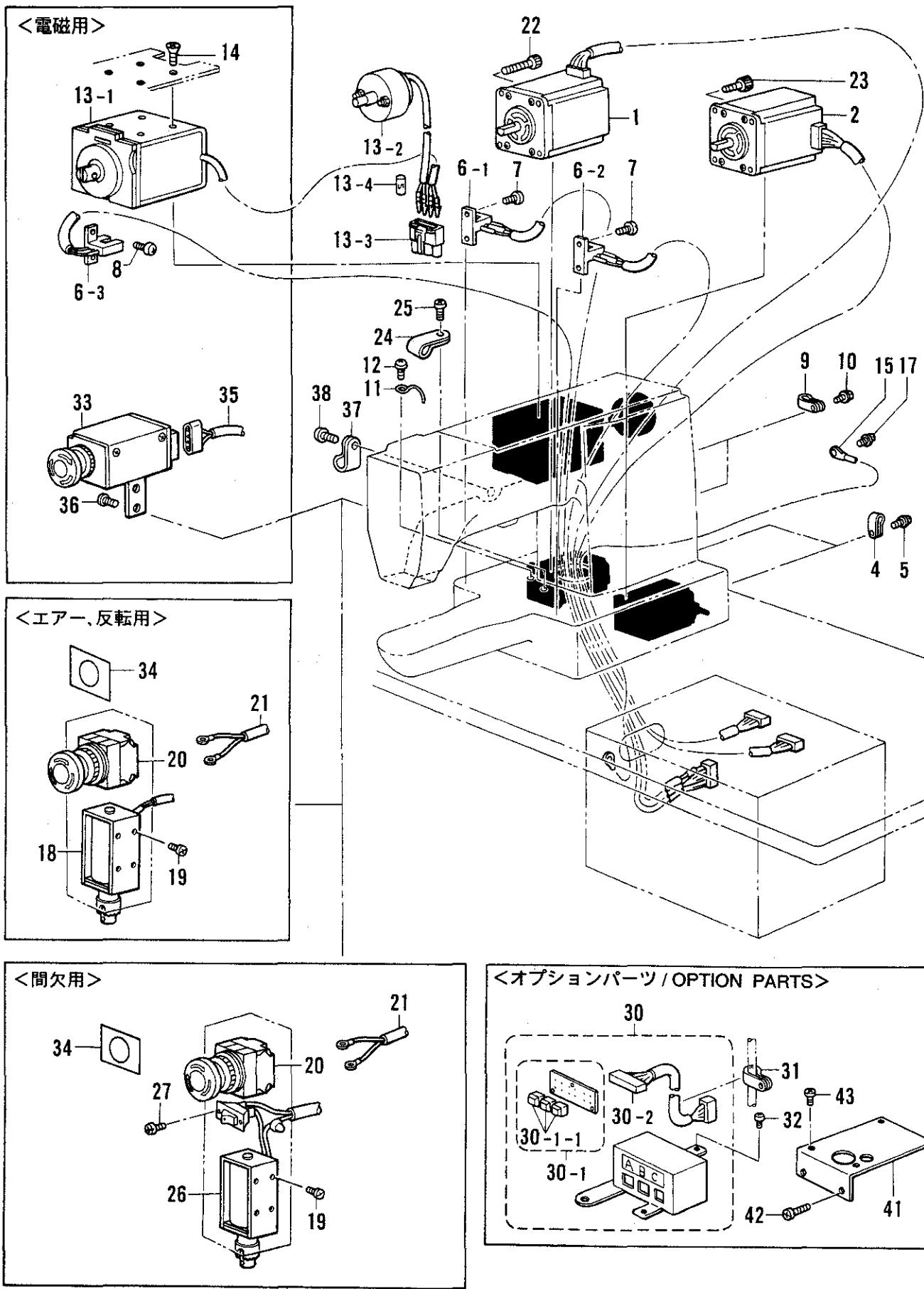
Q. 電装品関係 / Power supply equipment mechanism / Stromversorgung / Mécanisme de l'équipement en alimentation électrique / Mecanismo del equipo de alimentación de corriente
