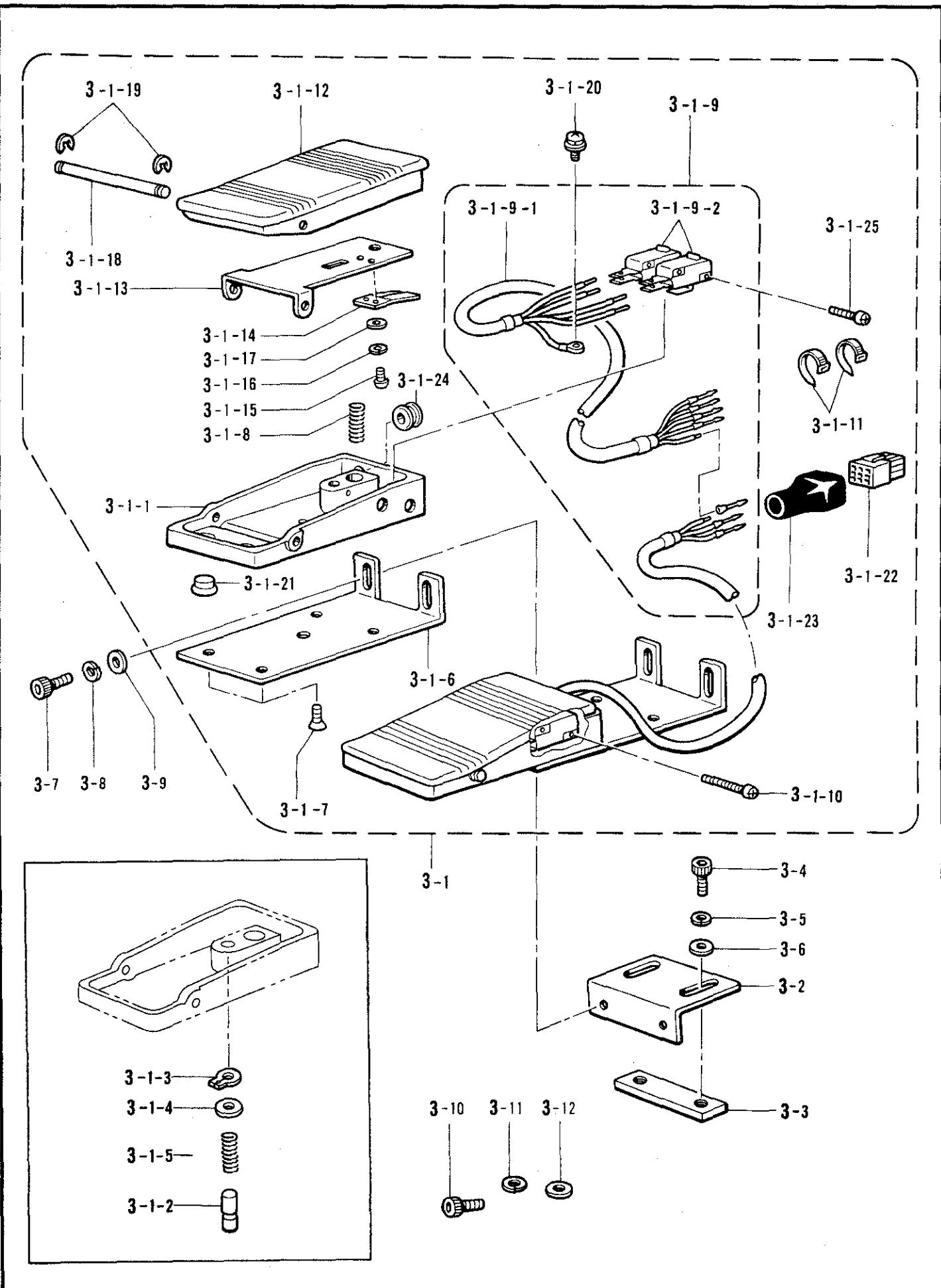
T3 . 踏板関係 / Foot switch pedal mechanism / Fußbetätigung / Mécanisme de la pédale / Mecanismo del pedal
