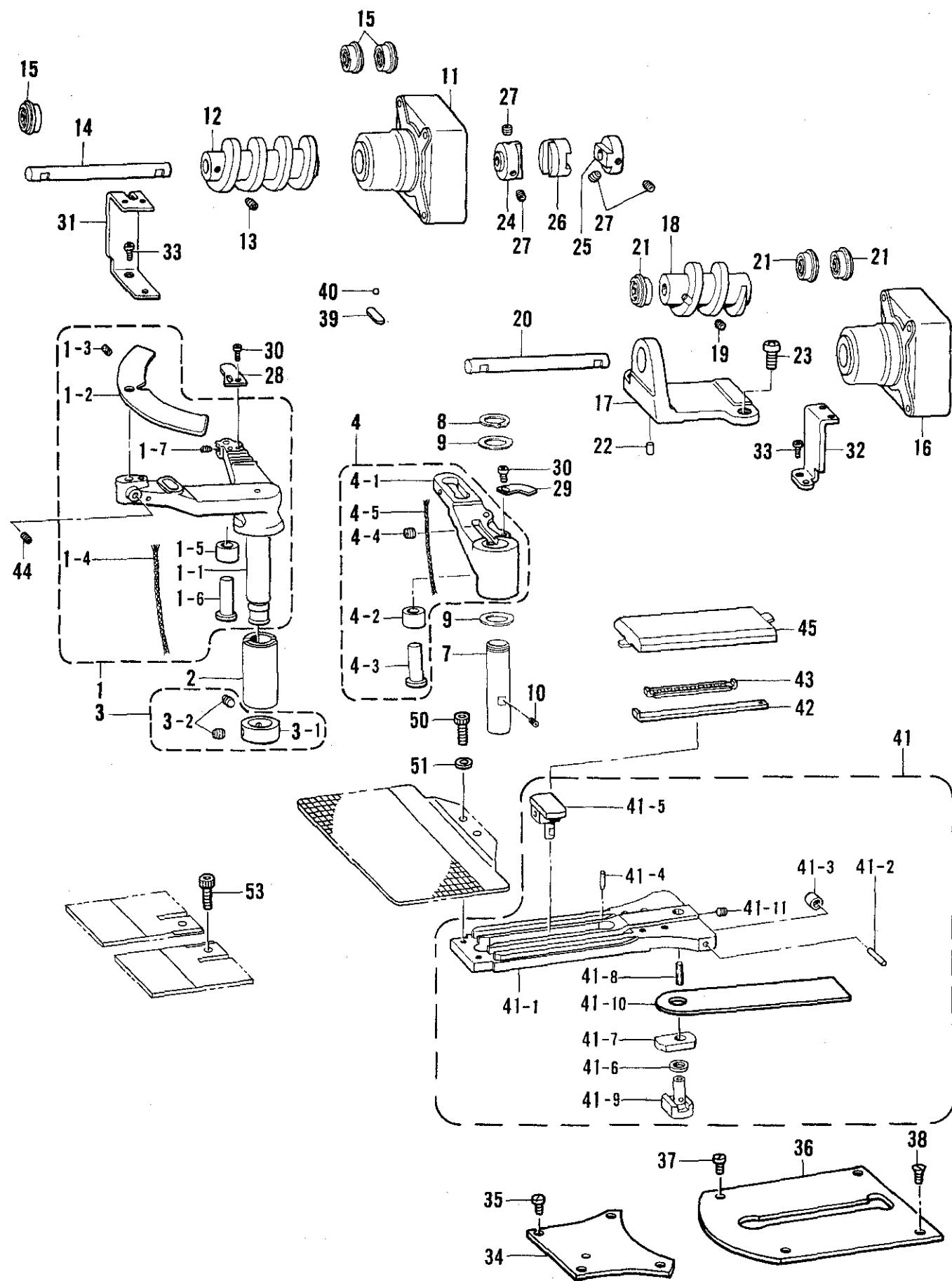
C1. 送り関係 / Feed mechanism / Transportvorrichtung / Mécanisme de l'entraînement /
