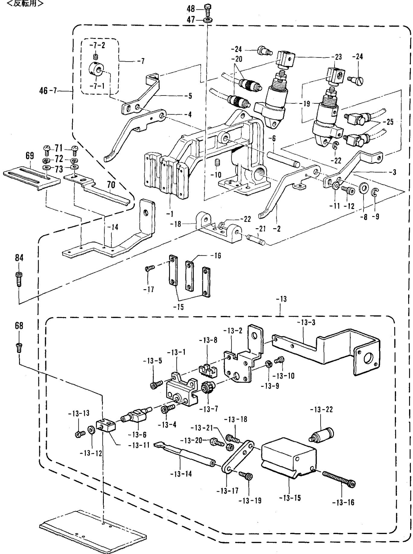
C4. 送り関係 / Feed mechanism / Transportvorrichtung / Mécanisme de l'entraînement / Mecanismo de la alimentación
