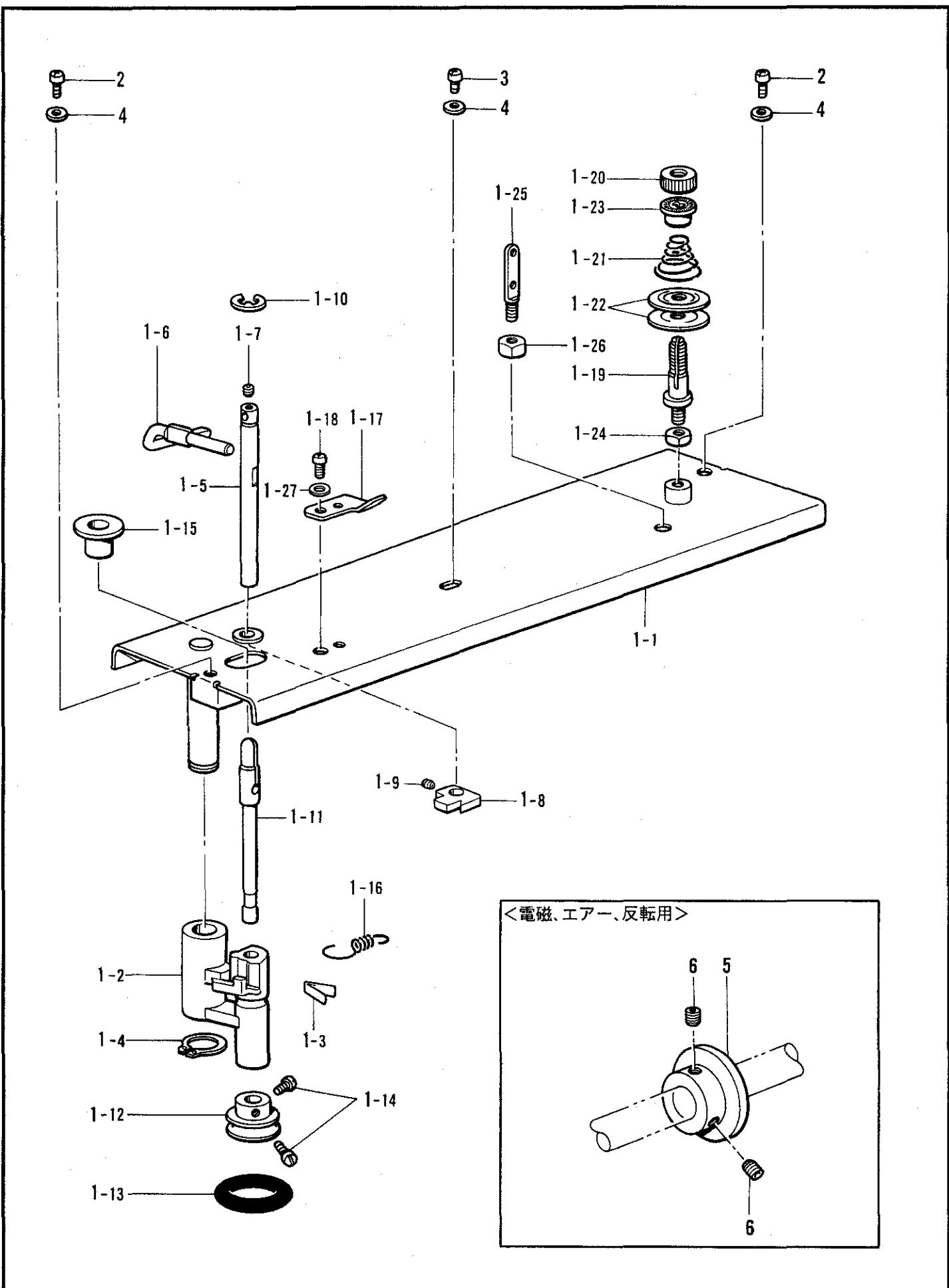
H. 糸巻関係 / Bobbin winder mechanism / Spuler / Mécanisme du bobineur / Mecanismo del devanador de la canilla
