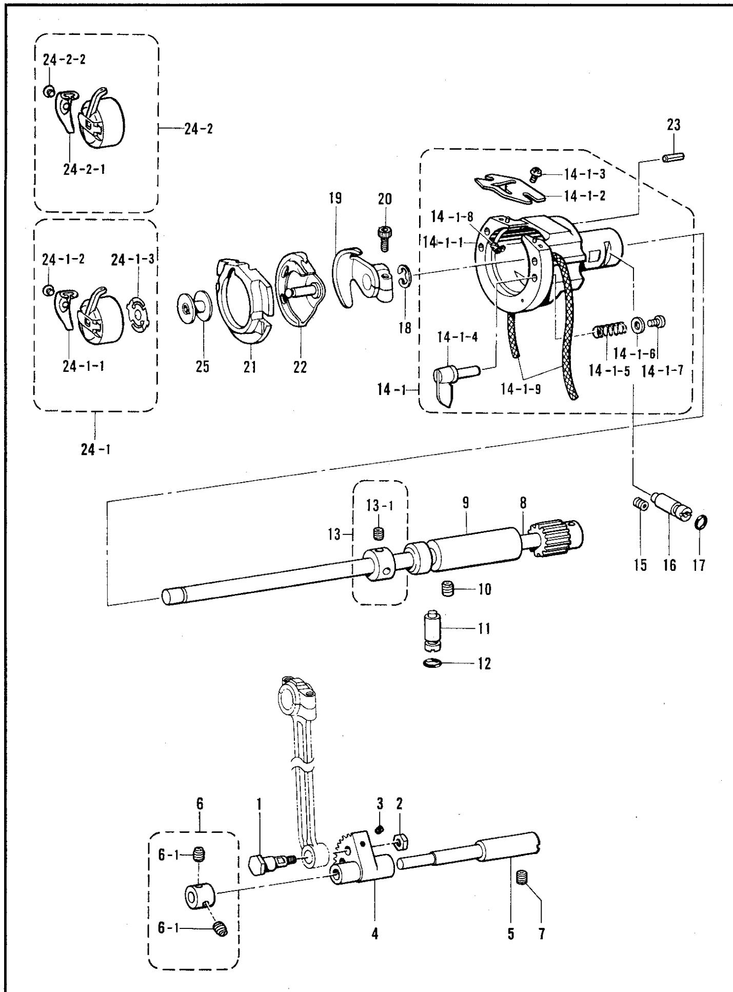
E. 下軸関係 / Lower shaft mechanism / Untere Welle / Mécanisme de l'arbre inférieur /
